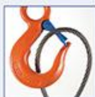
ワイヤロープのヨリが発生し、回転した状態
